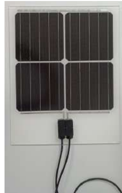
Yüksek Sıcaklık Pastası Uygulanmış Panel
