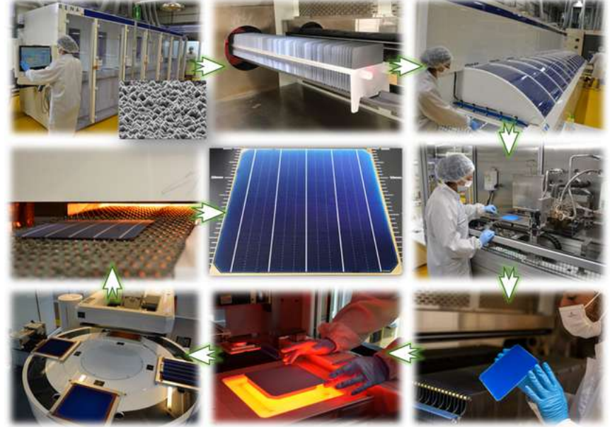
PERC+ Hücre Üretim Akışı ODTÜ-GÜNAM Fotovoltaik Pilot Üretim Hattı (GPVL)
