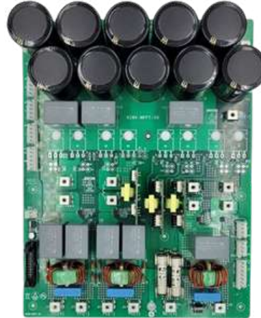
MPPT ve Batarya Şarj/Deşarj için İlk Prototip (4. Dönem)
