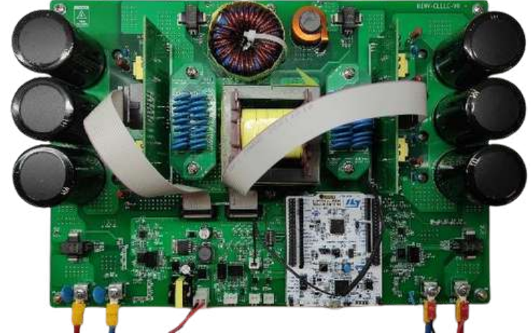
Batarya Şarjör Devre Prototipi (6. Dönem)
